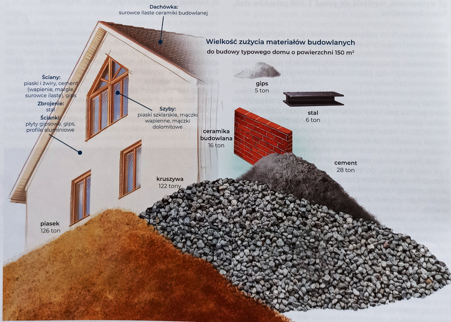
Fig. 4. Najważniejsze materiały budowlane i wielkość ich zużycia do budowy typowego domu o powierzchni 150 m 2 .
