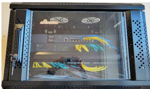
Rys. 7. Okablowanie sieciowe w szafie dystrybucyjnej.
